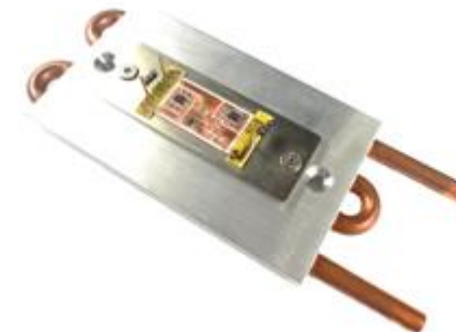
Siliziumkarbid-Testmodul vor der thermischen Charakterisierung
